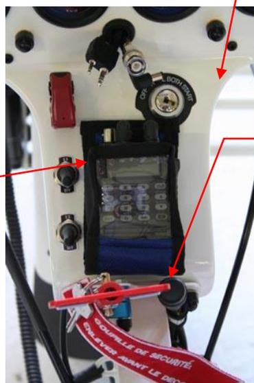
Alimentation : batterie tampon 12V-7Ah ou de démarrage moteur Protection : fusible ou breaker 3 A
