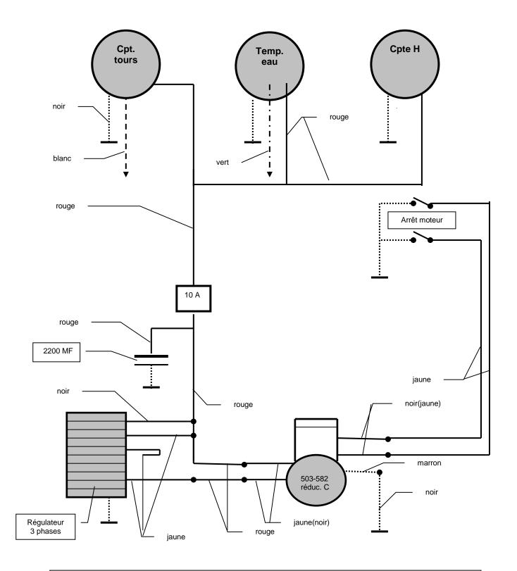
Les couleurs des fils des faisceaux électriques sont données à titre indicatif. Lors des interventions, il est donc nécessaire de tester chaque fil afin de confirmer son branchement.
