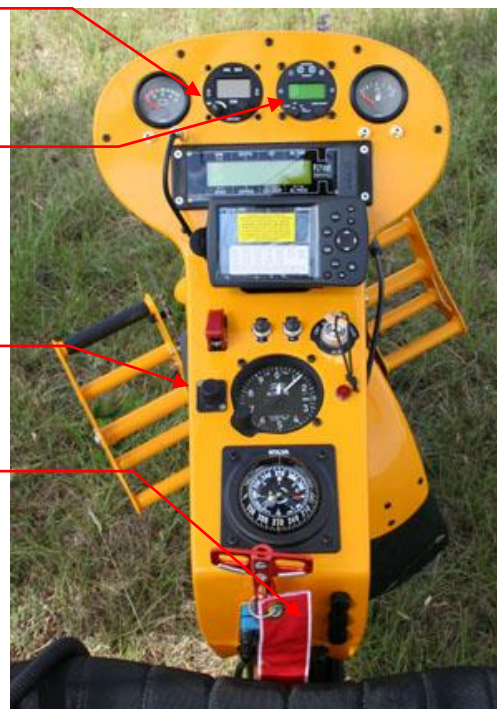
Alimentation : batterie tampon 12V-7Ah ou de démarrage moteur - Fusible ou breaker 3A
