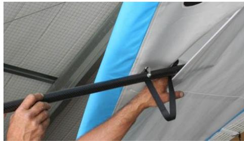
22° Verrouiller le balestron avec son push-pin. Poser la rondelle de sécurité
