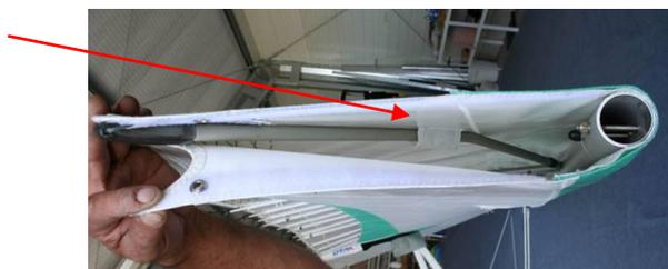
26° Fermer la trappe recouvrant les câbles de tension de transversales
