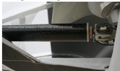
24° Insérer les floating Droite et Gauche dans leur lumière, Le tube de floating est positionné impérativement sous le tube reliant le floating au balestron
