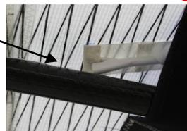
19° Poser les lattes d'intrados (le creux vers le tube de bord d'attaque – embout rouge à G noir à D)
