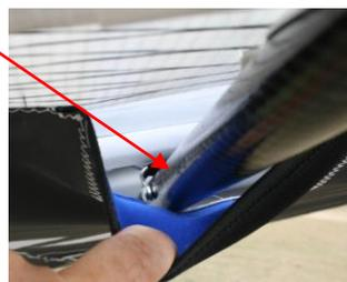
21° Positionner l'embase de balestron : la sangle doit être rectiligne, sans « twist »
