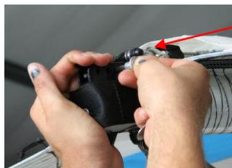
15° Approcher les haubans du cardan inférieur et boulonner, écrou papillon vers l'avant.
