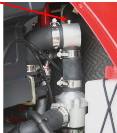
**Frein hydraulique : purger le circuit de frein et remplacer ou compléter le liquide de frein (Op. 94, 95 / 255, 256 / 397)**
