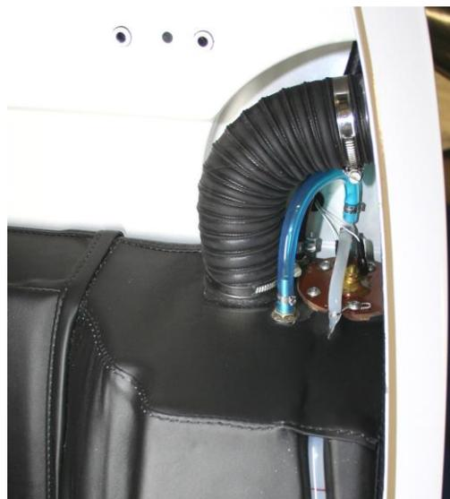
⇒ Retirer la purge - la bague épaulée d'étanchéité reste sur le réservoir (MG-17)
