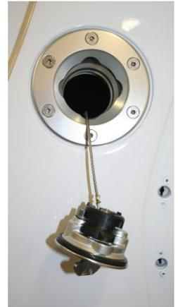
⇒ Retirer le tuyau de remplissage côté réservoir (MG-16)
