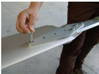
4° : Insérer les vis de fixation par-dessus sans oublier la rondelle sous la tête de vis.
