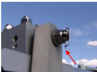
4° : Serrer l'écrou sans bloquer de façon à aligner le trou de la vis, puis **positionner la goupille de sécurité (
