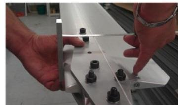
Note : Si la cote n'est pas identique, desserrer légèrement les vis de fixation de la pale. Protéger le porte-pales avec un morceau de bois, puis taper légèrement avec un maillet sur le bord du porte-pales pour déplacer la pale en latéral.
