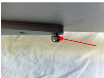
5° : Mettre en place rondelles et écrous (
