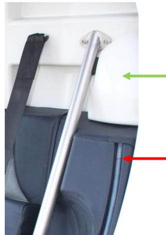
Note : pour les vols de longue durée, seul à bord, un réservoir d'appoint amovible, souple, conçu pour l'usage aéronautique, type « Little-Buddy 10.5 Gal (40 litres) TURTLEPAC, peut être attaché sur le siège arrière.
