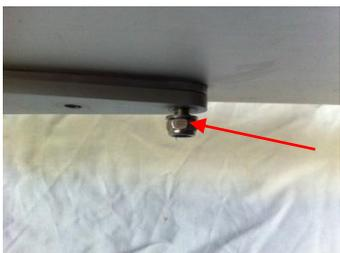
5° : Mettre en place rondelles et écrous.
