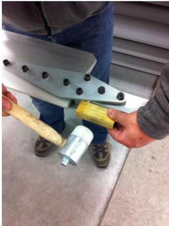
Note : Si la cote n'est pas identique, desserrer légèrement les vis de fixation de la pale. Protéger le porte-pales avec un morceau de bois, puis taper légèrement avec un maillet sur le bord du porte-pales pour déplacer la pale en latéral.
