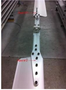
4° : Mesurer à l'aide d'une équerre la distance entre le fil et le bord d'attaque de la pale sur le point N°1 et sur le point N°2. La distance doit être identique.
