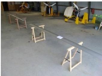
1° : A l'intérieur d'un bâtiment et sur un sol plan, présenter les pales l'une en face de l'autre sur 4 supports
