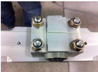
3° : Ecarter les supports afin que La distance entre le fil de nylon et le porte-pales soit de 1 à 2 MM.
