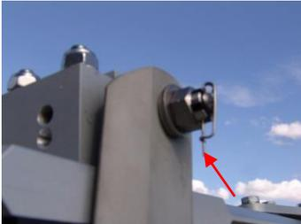
4° : Serrer l'écrou sans bloquer de façon à aligner le trou de la vis, puis **positionner la goupille de sécurité** (
